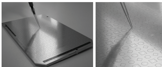
7-24. ábra. A MALDI TOF tömegspektrometriánál használatos, a minta töményítésére is alkalmas rozsdamentes acél mintatartó tálca
