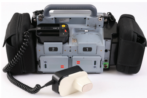
1.6. ábra. A standard lapátelektrodára húzott átalakító a Lifepak 15 készülékhez
