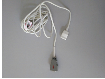
2.3. ábra. Kábel az ujjra ragasztható pulzoximéter-szenzorhoz
