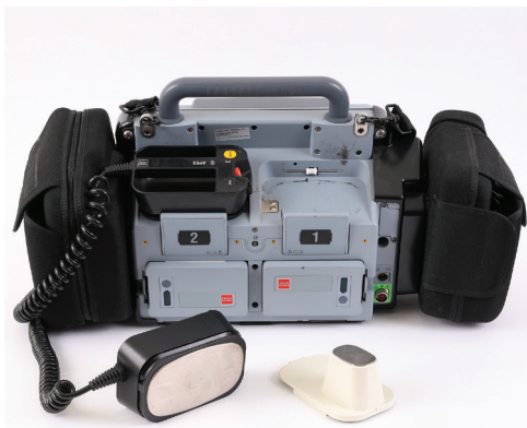
1.5. ábra. Gyermekellátás közben alkalmazható átalakítólapátok a Lifepak 15 készülékhez
